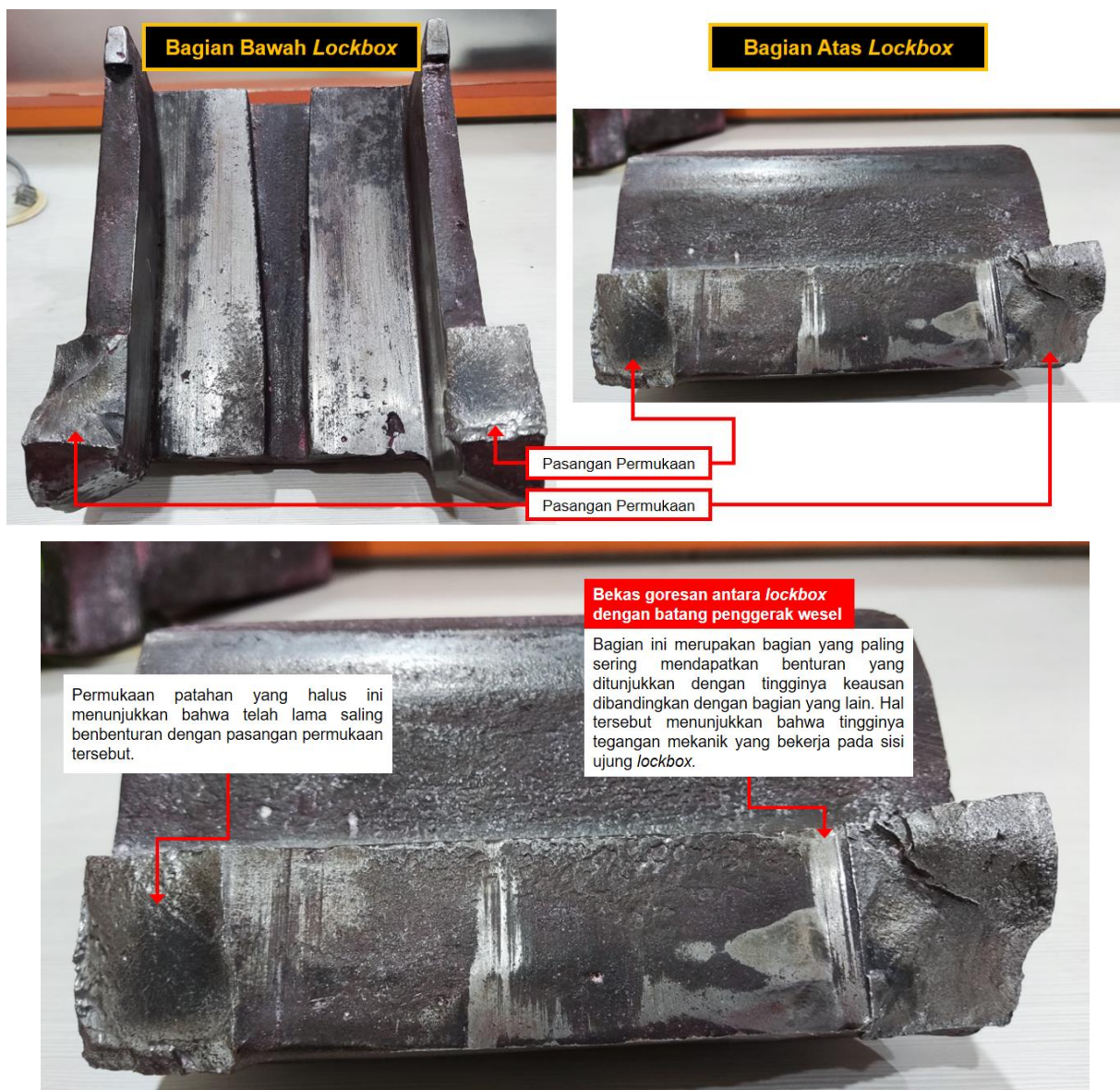
Gambar 26. Analisis kegagalan komponen Lockbox
