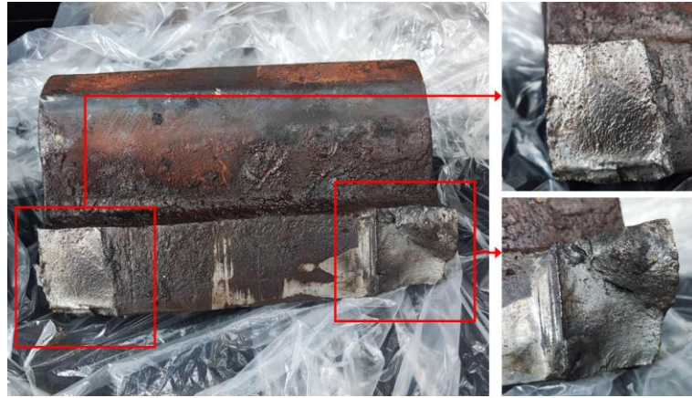
Gambar 7. Patahan Lockbox Wesel 1 bagian atas
