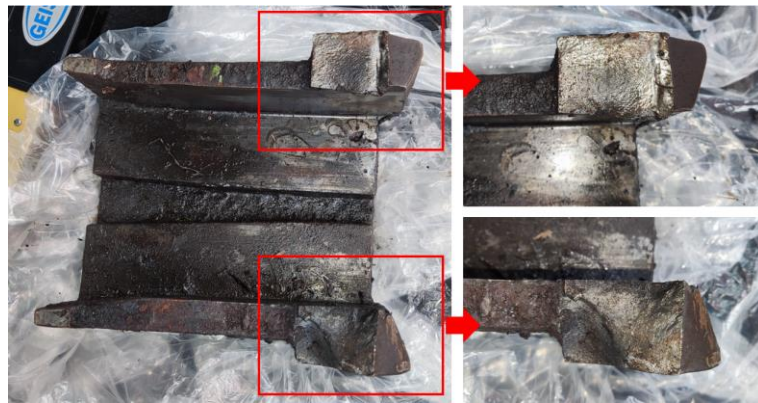
Gambar 8. Patahan Lockbox Wesel 1 bagian bawah
