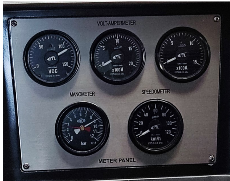
Gambar 14. Meter Panel di kabin Kereta Api Bandara
