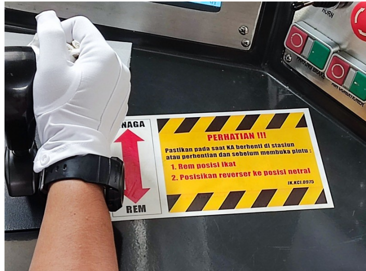
Gambar 28. Sticker di driver desk yang memuat instruksi penting untuk setiap ASP yang mengoperasikan KA Bandara
