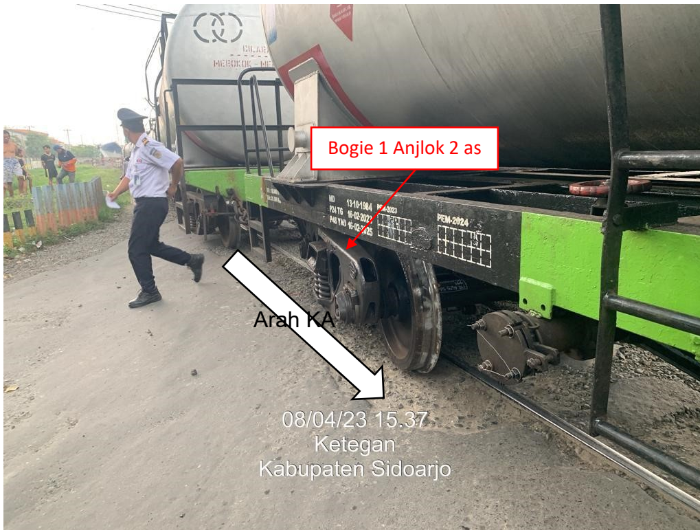
Gambar 1. Kondisi gerbong ke-4 KA 2636F (GK 308454) yang mengalami anjlok 2 as
