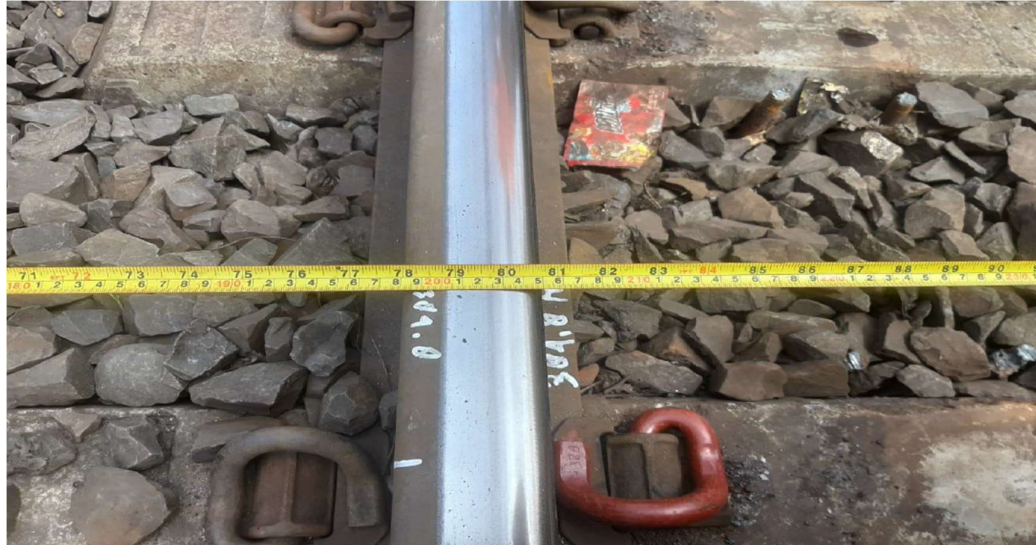
Gambar 11. Kontak roda dan rel selebar 40 mm
