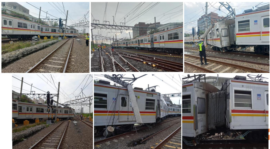
Gambar 3. Dampak kecelakaan anjlokannya KA D1/5144C KRL Commuter Line di Emplasemen Stasiun Kampungbandan
