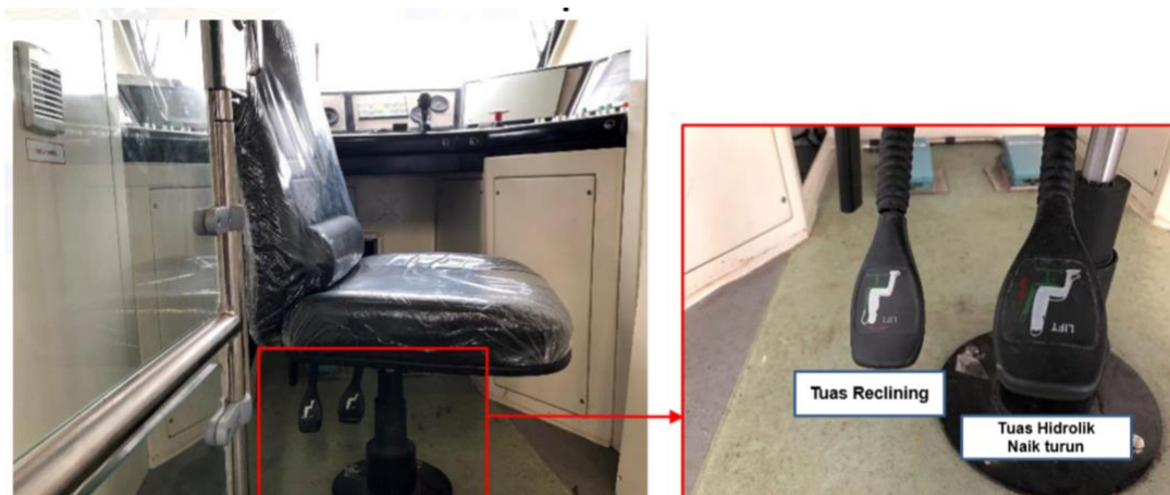
Gambar 26. Tempat duduk Train Driver LRT Jabodebek
