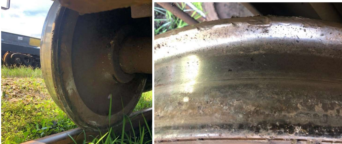
Gambar 7. Kondisi flens roda GB 50514 222 (gerbong ke 30) setelah anjlok
