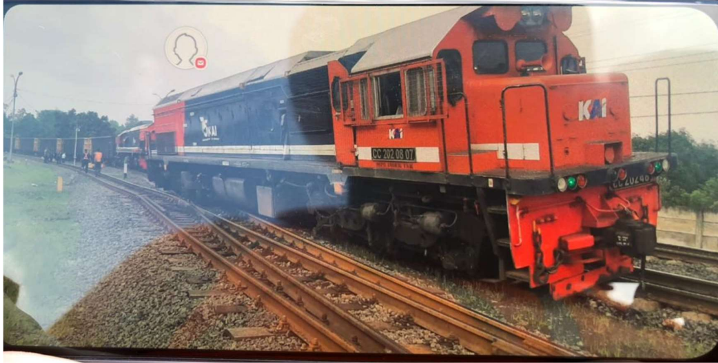
Gambar 9. Dokumentasi Anjlokkan Lokomotif CC 202 08 07 di Wesel 23B1
