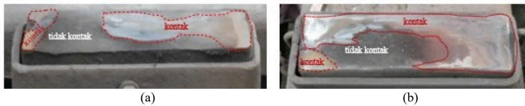
Gambar 10. Kondisi area kontak pada permukaan lower side bearer bogie I GK 30 66 07 (a) kiri; (b) kanan.
