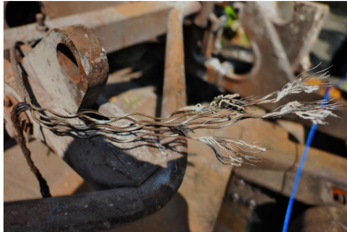
Gambar 21. Lepasnya untaian dari tiap strand dan wire secara terpisah pada komponen safety band steel wire rope tipe 6 x 19 IWRC Galvanis
