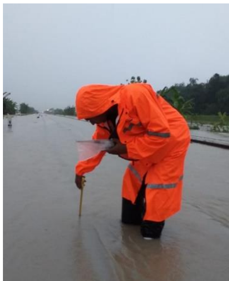
Gambar 14. Banjir dengan ketinggian muka air pada jalur hilir \pm 18 cm dari kepala rel
