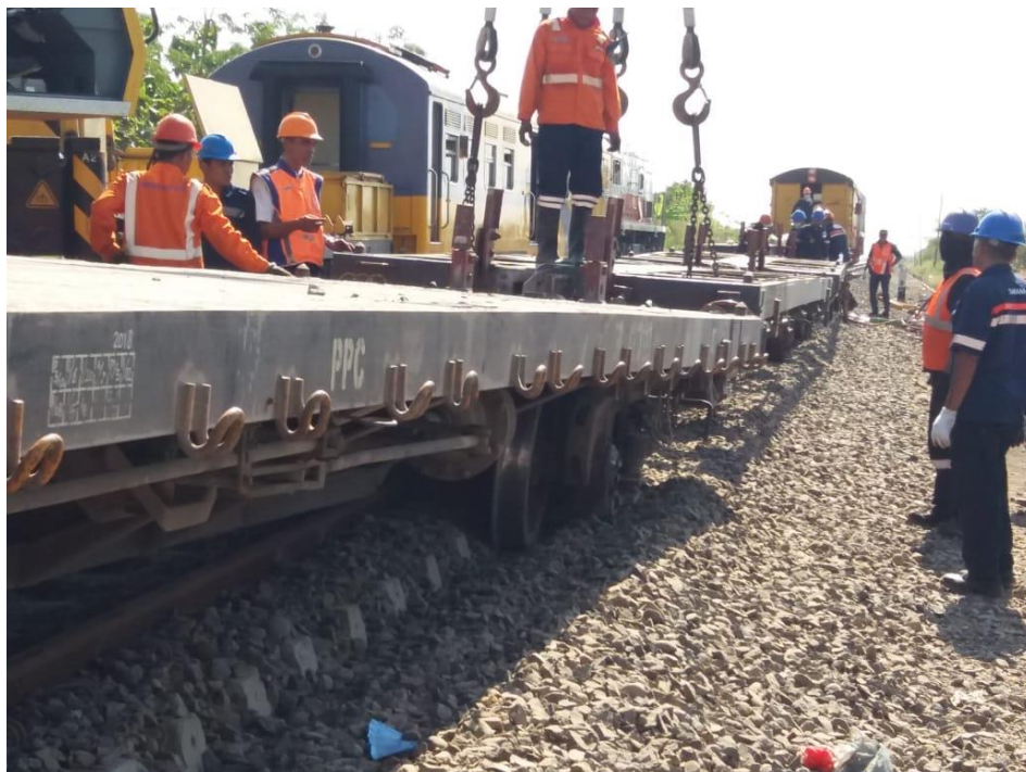
Gambar 2. Proses evakuasi gerbong datar tanpa muatan yang anjlok
