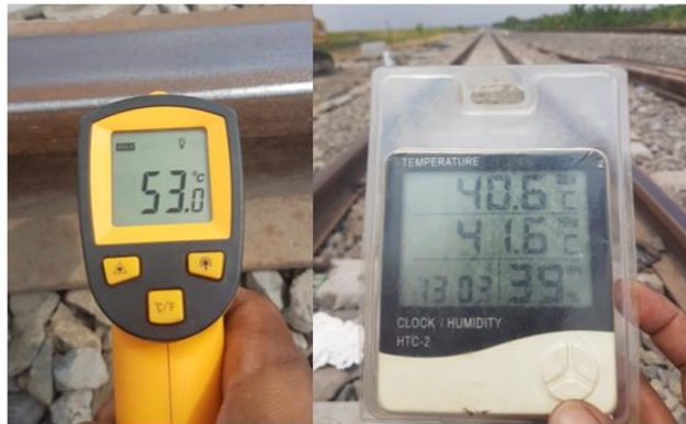
Gambar 11. Pengukuran temperatur rel dan udara pkl. 13.00 WIB setelah diganti dengan rel R54 tanggal 14 Agustus 2019 di lokasi kecelakaan
