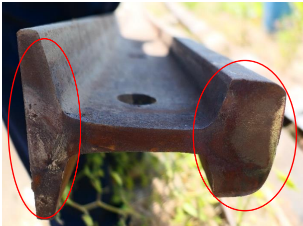
Gambar 6. Jejak benturan pada permukaan rail end
