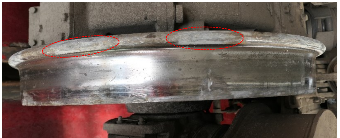
Gambar 15. Terdapat benturan pada roda 2 kereta 8612
