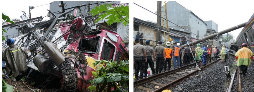
Gambar 4. Tiang LAA rubuh dampak anjlokkan KA 1722
