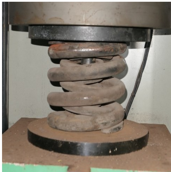
Gambar 13. Pengukuran pegas primer kereta 8612 dengan alat uji coil spring
