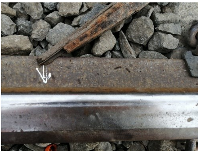
Gambar 7. Jejak pada kepala rel akibat impak roda yang anjlok
