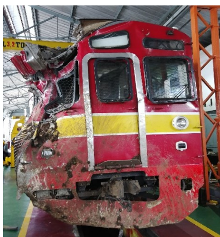
Gambar 6. Kondisi struktur kereta dampak anjlokkan
