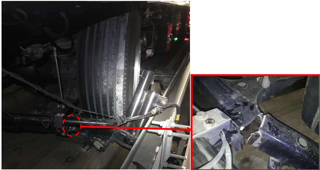
Gambar 5. Arm bogie atau rangka pengarah bogie yang patah karena benturan antara rel pengarah dan roda pengarah
