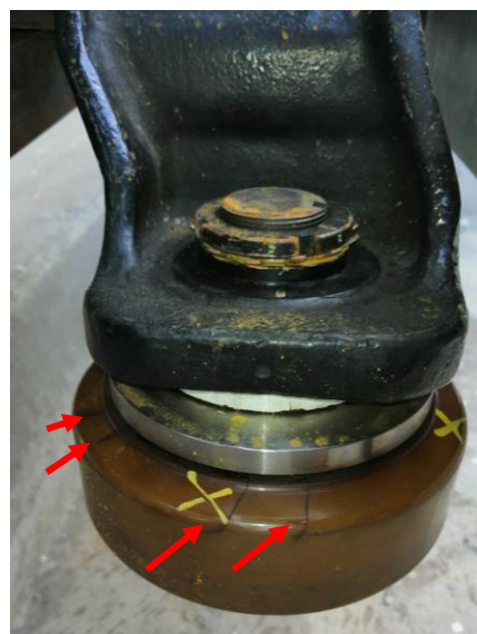
Gambar 10. Retak pada material Urethane dari roda pengalih kereta MC2 di rangkaian TS 2
