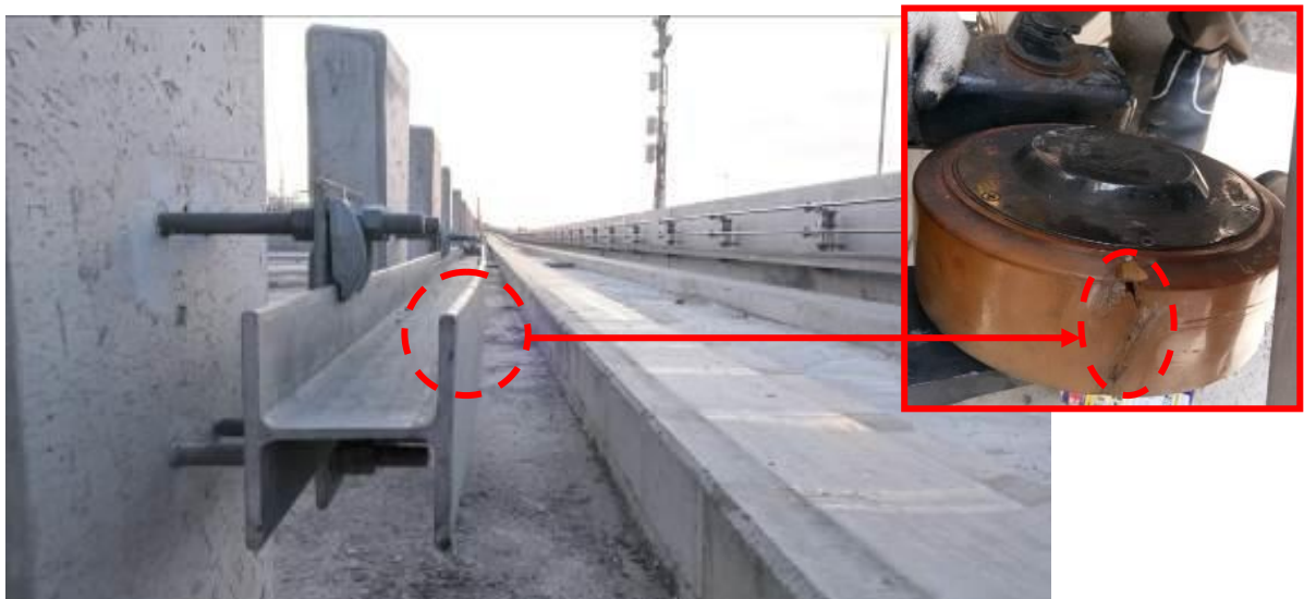
Gambar 4. Lokasi benturan antara ujung rel pengarah dan roda pengarah bogie kereta MC2 dari rangkaian TS 2
