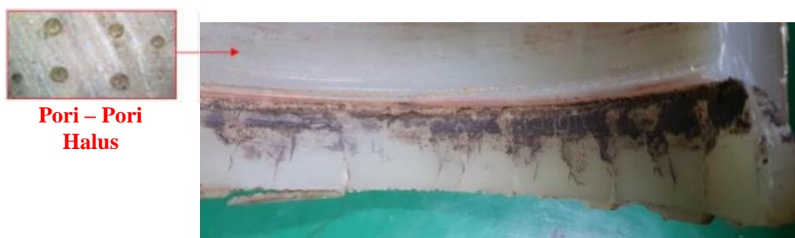
Gambar 14. Lapisan material Urethane roda pengarah dan pengalih yang retak serta pori – pori halus yang terbentuk
