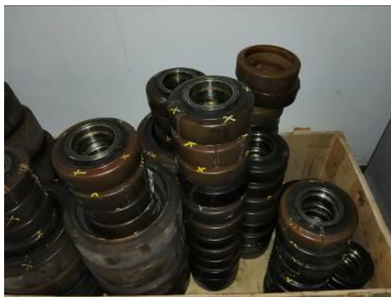
Gambar 11. Kondisi dari unit roda pengarah dan roda pengalih yang tidak dapat digunakan karena retak
