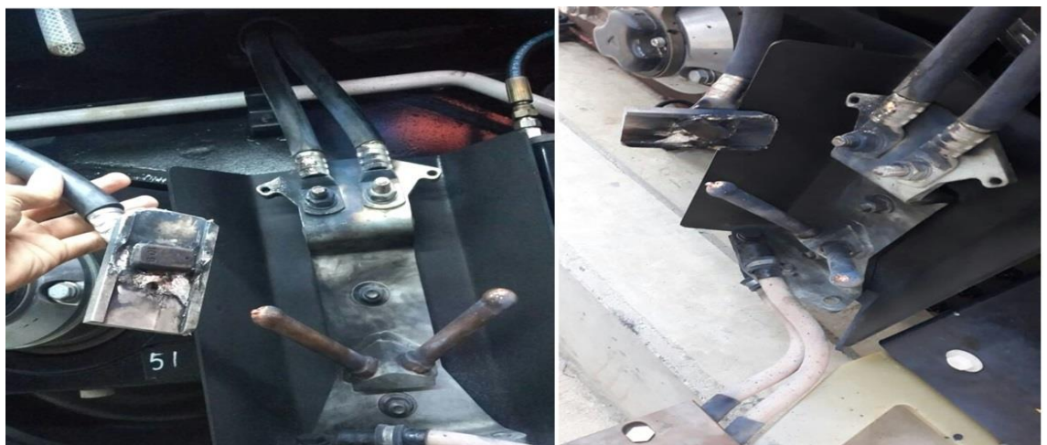
Gambar 35. Kabel Grounding dan Receiptacle Stinger pada KA 43 (TS-7)
