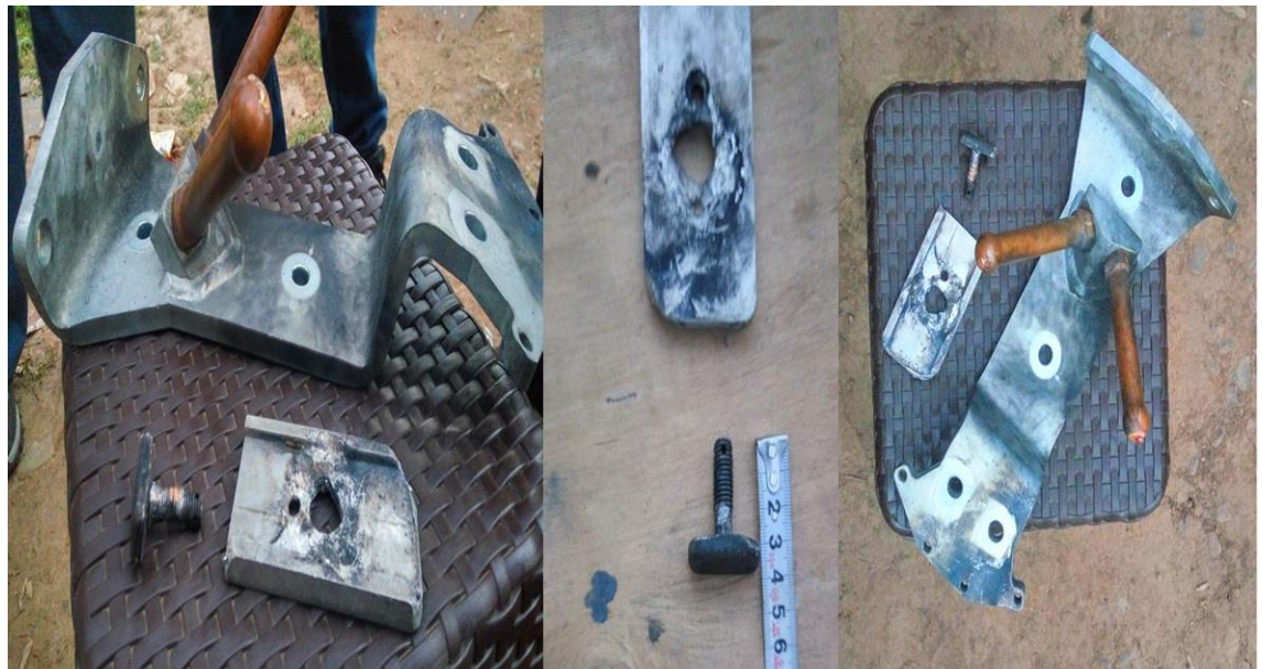
Gambar 36. Receiptacle Stinger , Bracket dan Fastening pada Instalasi Grounding
