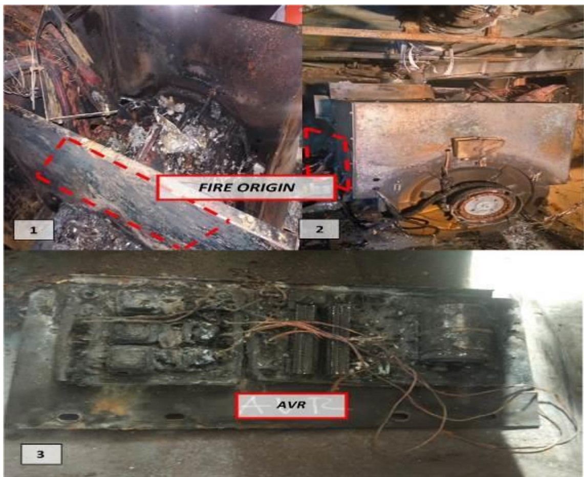
Gambar 31. Kemungkinan Fire Origin Kedua ( Generator )
