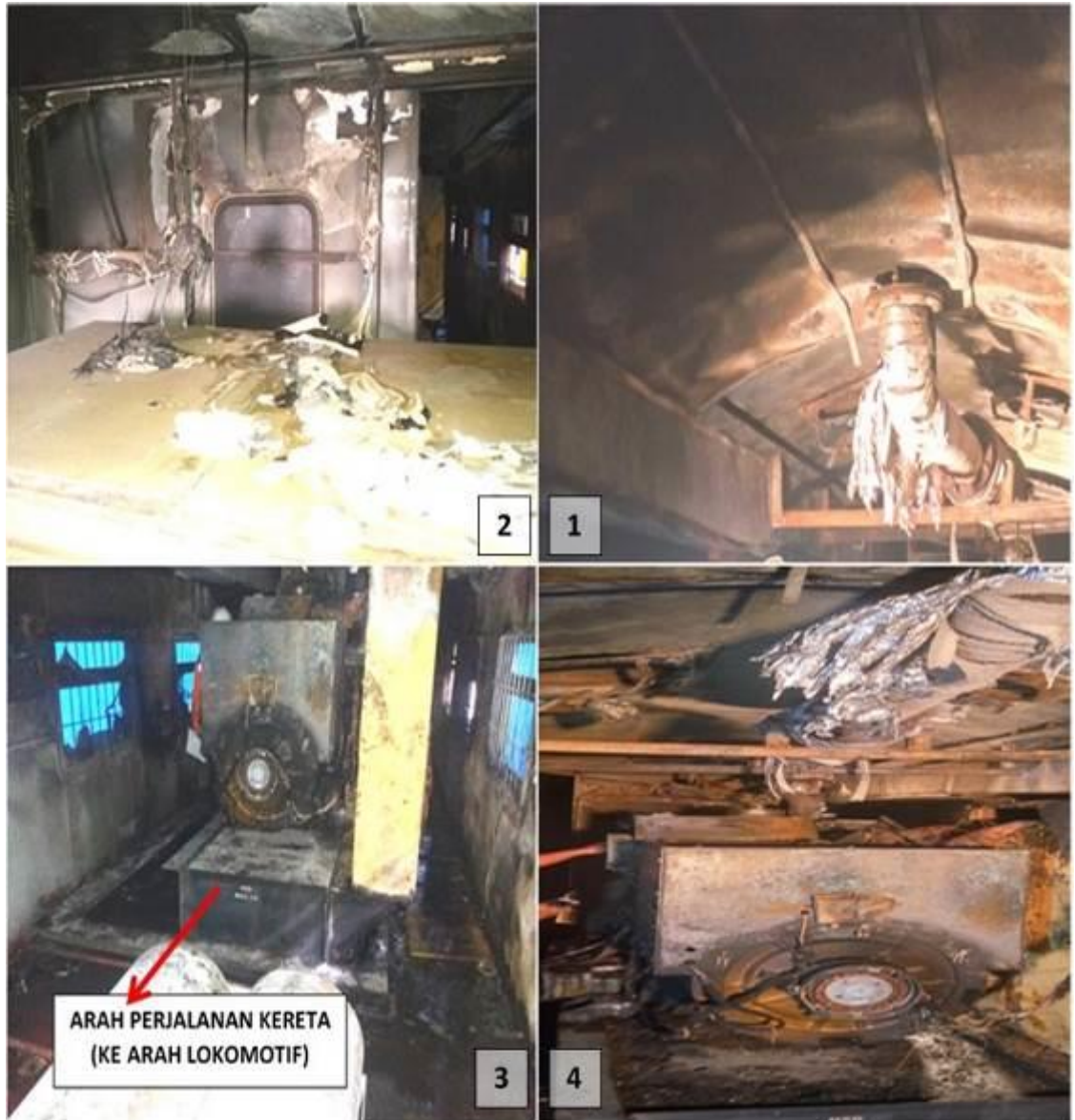
Gambar 7. Kerusakan Badan Kereta Pembangkit - Bagian Dalam
