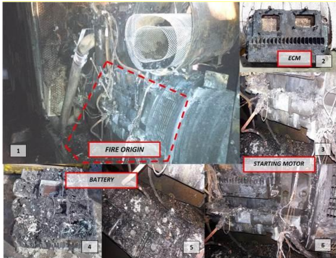
Gambar 30. Kemungkinan Fire Origin Pertama ( Engine )
