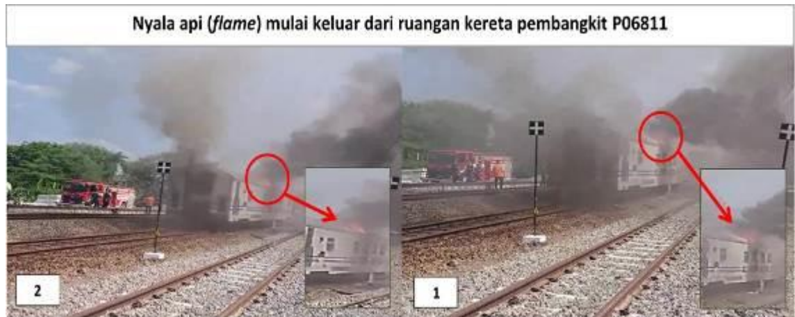
Gambar 26. Kondisi Flashover pada Kebakaran Kereta Pembangkit P06811
