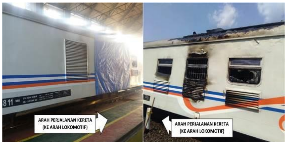
Gambar 6. Kerusakan Badan Kereta Pembangkit - Bagian Luar
