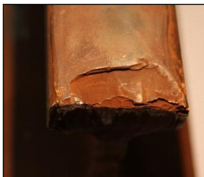
Gambar 2. Cacat pada permukaan kepala rel
