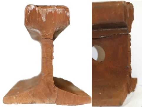
Gambar 4. Permukaan ujung rel pada sambungan tidak rata
