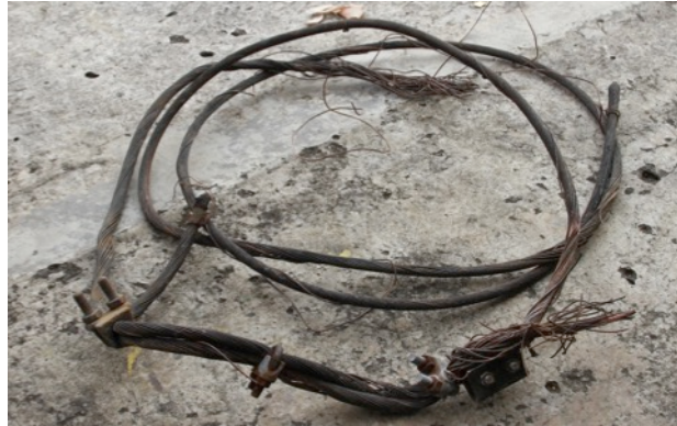
Gambar 4. Messenger wire rantas di bagian wire clamp
