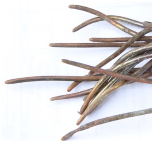
Gambar 20. End strands failure pada messenger wire
