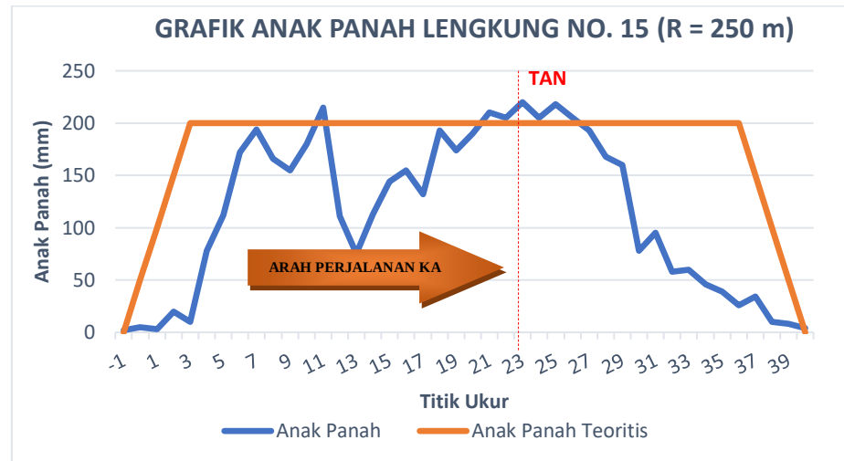
Gambar 16. Grafik hasil pengukuran anak panah lengkung no. 15 setelah kejadian
