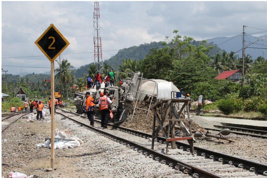
Gambar 5. GK yang anjlok dan terguling di emplasemen St. Pauhlina
