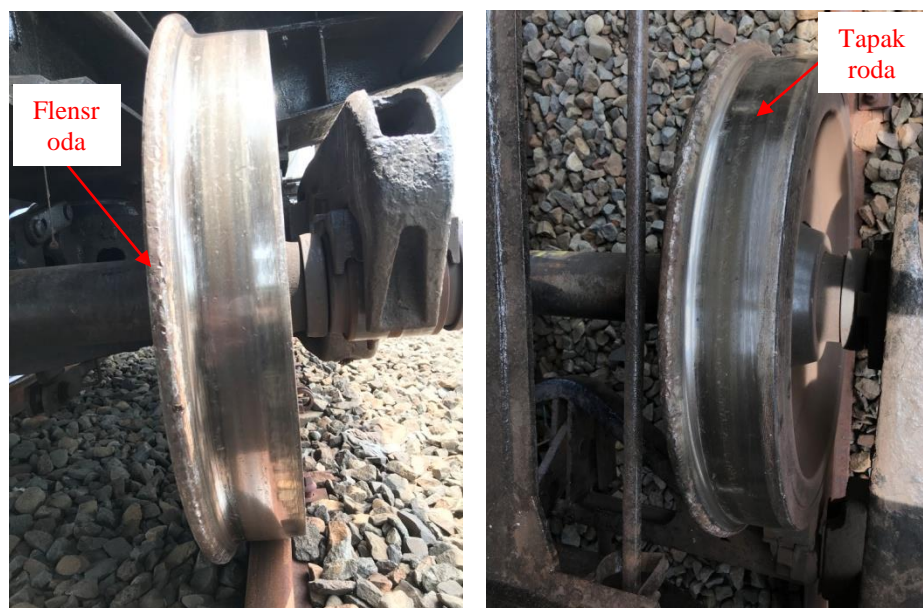
Gambar 4. Kerusakan pada flens dan tapak roda gerbong GK 30 77 19
