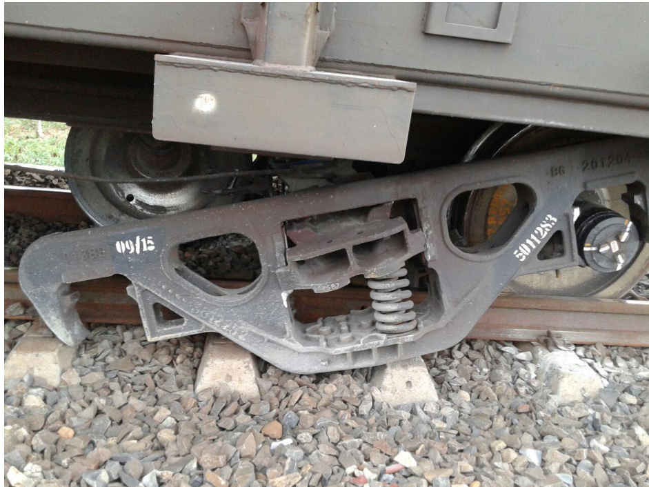
Gambar 4. Bogie belakang gerbong ke-31 (GB 50 11 283) mengalami patah 1 (satu) as dan anjlok 1 (satu) as.
