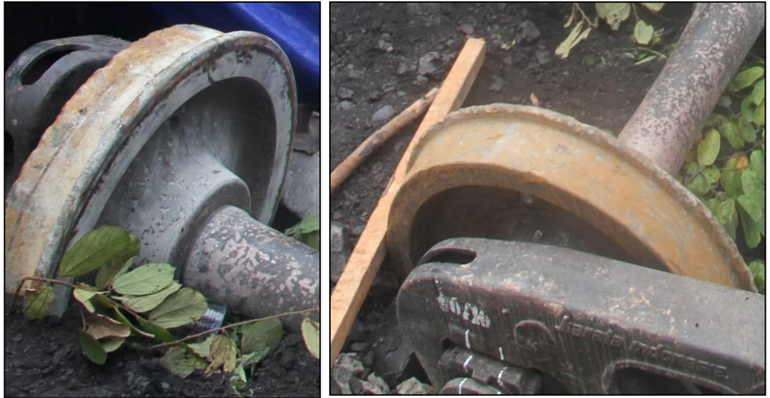
Gambar 12. Kerusakan Permukaan Tapak Roda dan Flens Roda pada gerbong GB 50 90 114
