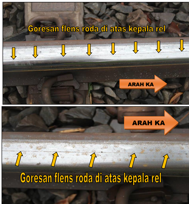
Gambar 10. Goresan flens roda di atas kepala rel yang terlihat
