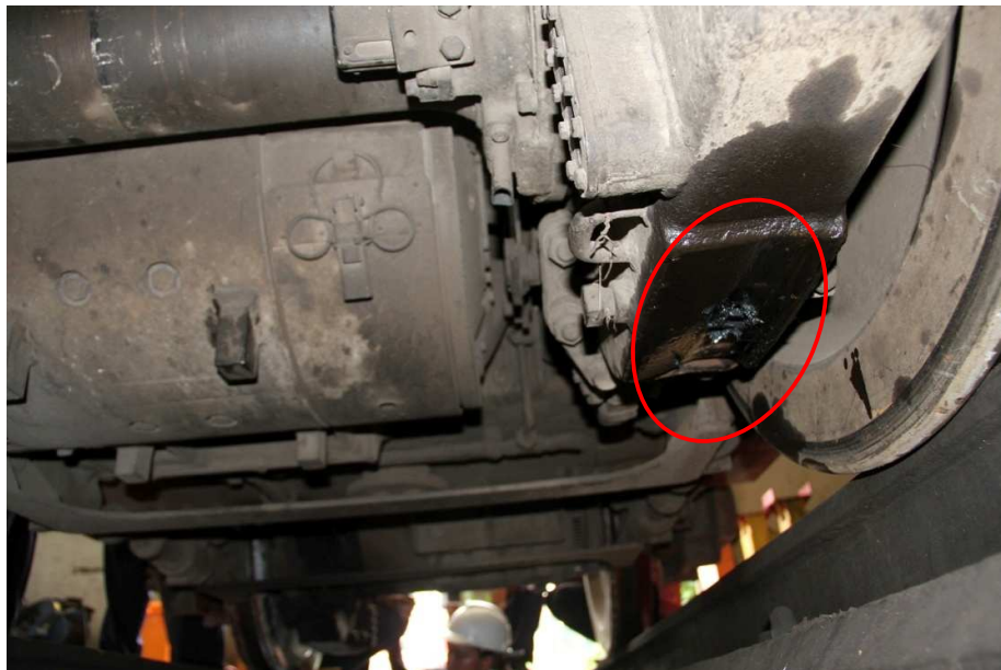
Gambar 4. Housing motor traksi K1 1 0807 yang rusak
