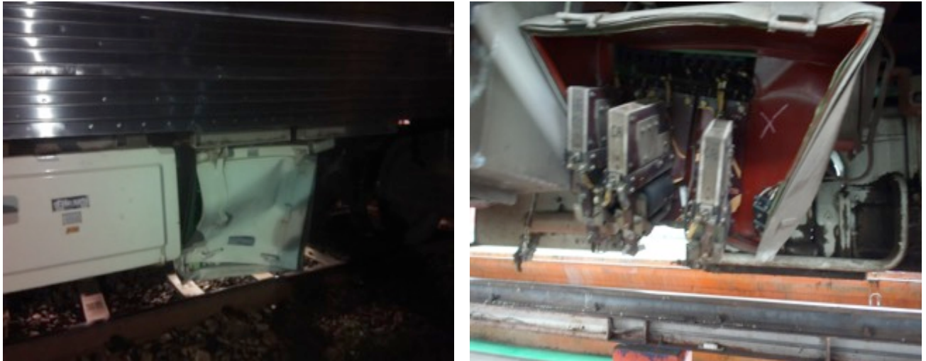
Gambar 3. Kerusakan pada komponen bagian bawah K1 10747
