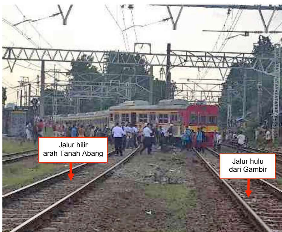
Gambar 2 . K1 10747 yang anjlok dan melintang di emplasemen St. Manggarai
