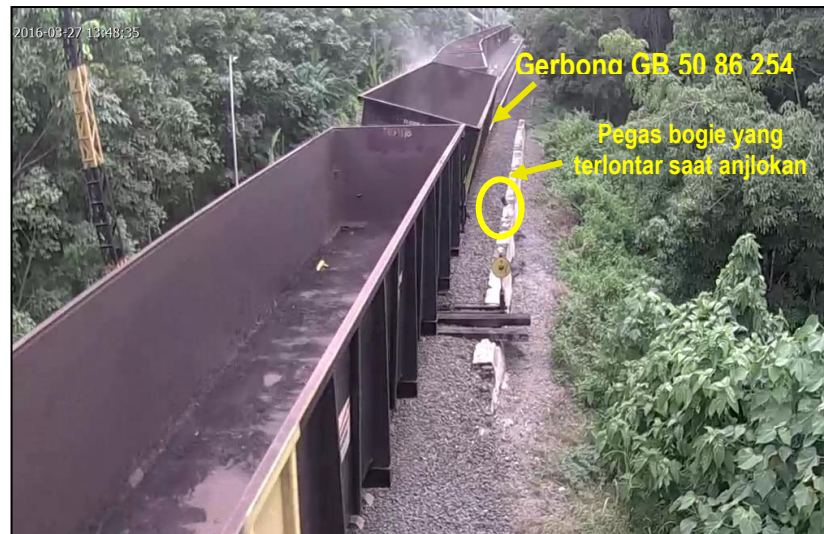
Gambar 7. Gerbong dari KA 3032 yang anjlok
