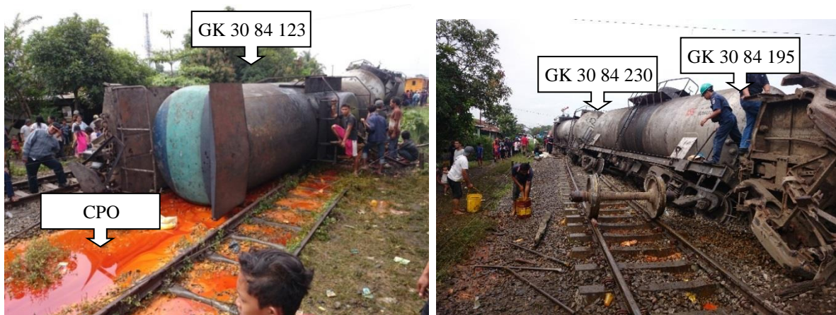
Gambar 3. Gerbong ke-2 (GK 30 84 123) yang anjlok dan terguling (kiri) serta 5 (lima) gerbong di belakangnya (kanan)
