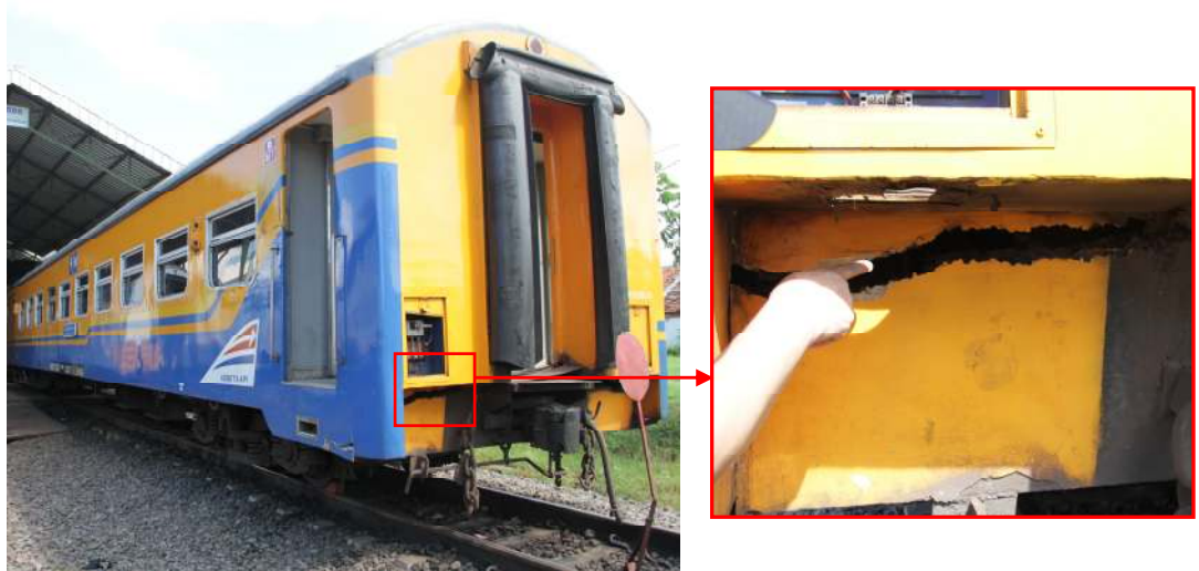
Gambar 4. KMP3 06519 yang mengalami rusak ringan
