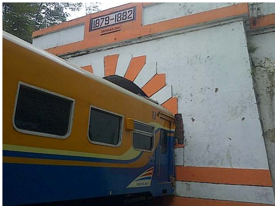
Gambar 3. Kereta keenam K3 00407 anjlok dan menabrak dinding ujung terowongan
