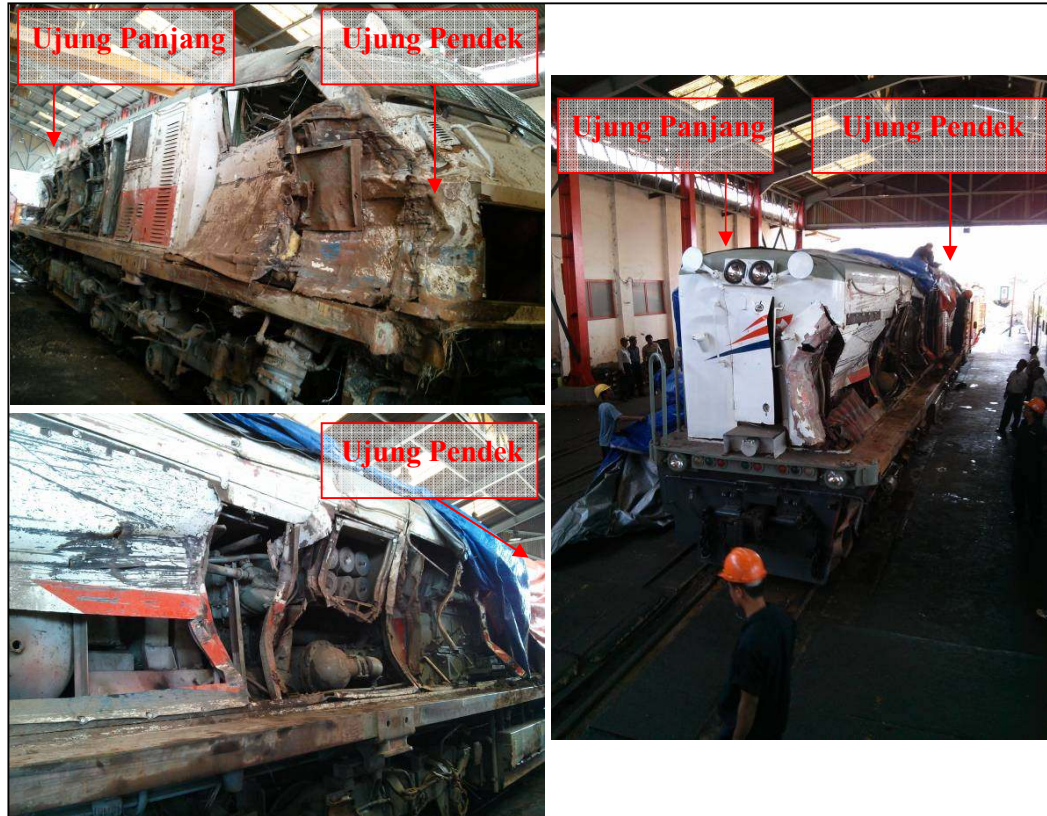
Gambar 3. Lokomotif CC 2039816 rusak berat pada sisi kanan ujung pendek dan rusak ringan pada sisi kanan ujung panjang
