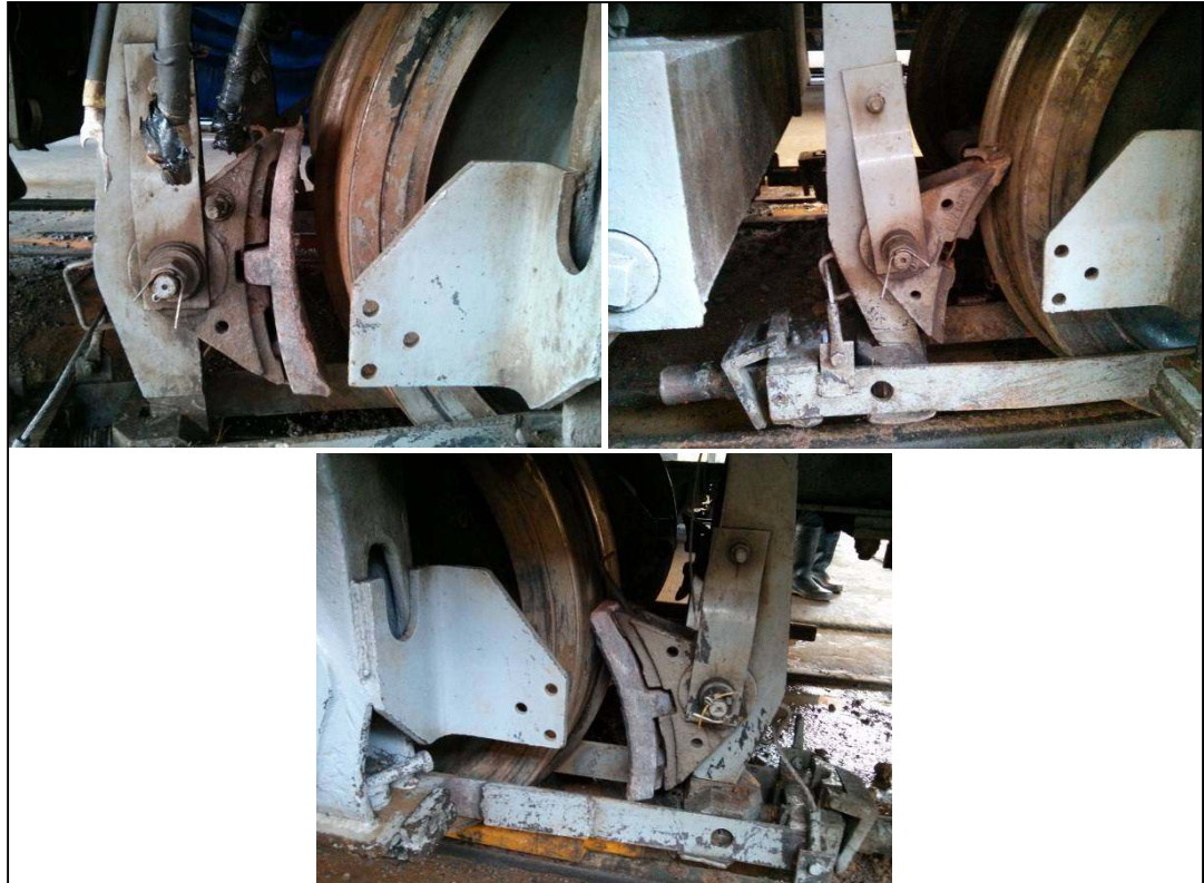
Gambar 4. Blok rem Lokomotif CC 2039816 rusak dan hangus bekas terbakar
