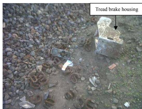
Gambar 6. Tread brake housing ditemukan sekitar 70 meter dari titik awal anjlokkan (foto rekonstruksi)
