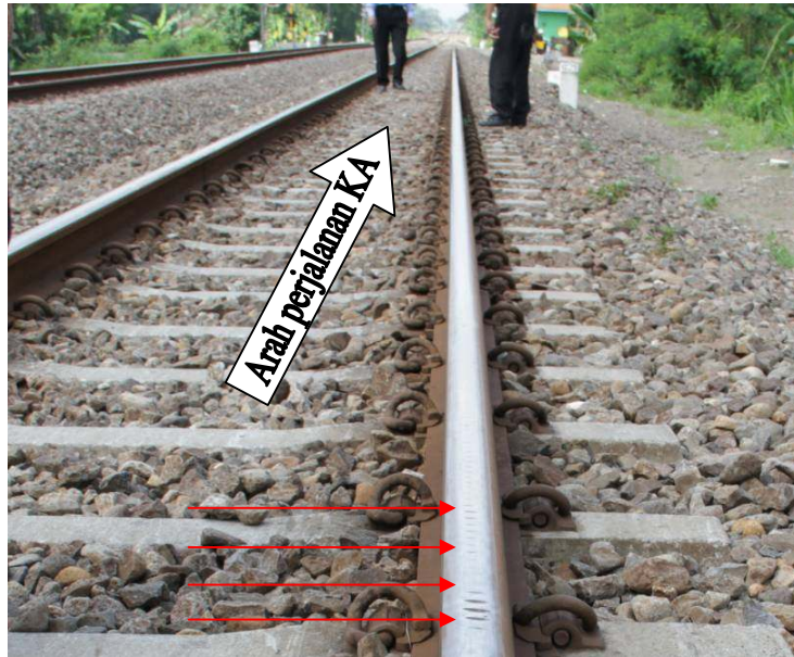
Gambar 20. Bekas injakan bull gear pada kepala rel
