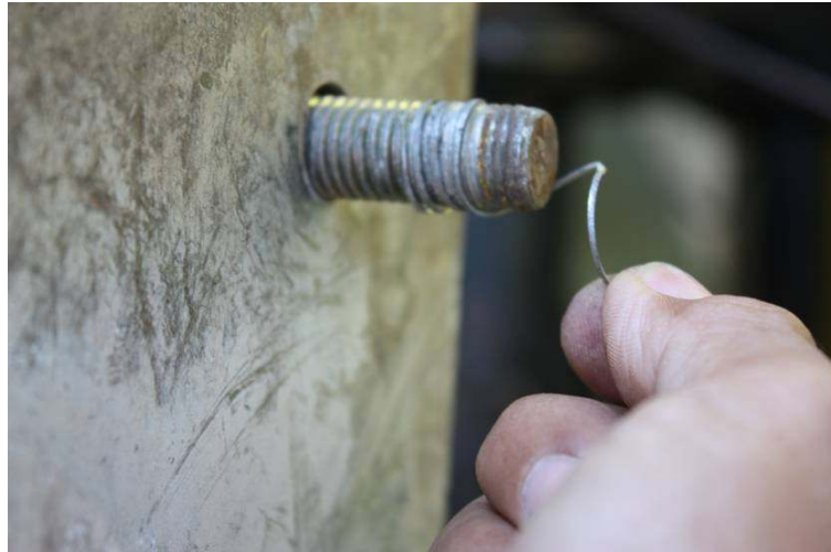
Gambar 16. Serpihan dari ulir mur dan ulir rangka bogie yang masih terilit di baut
