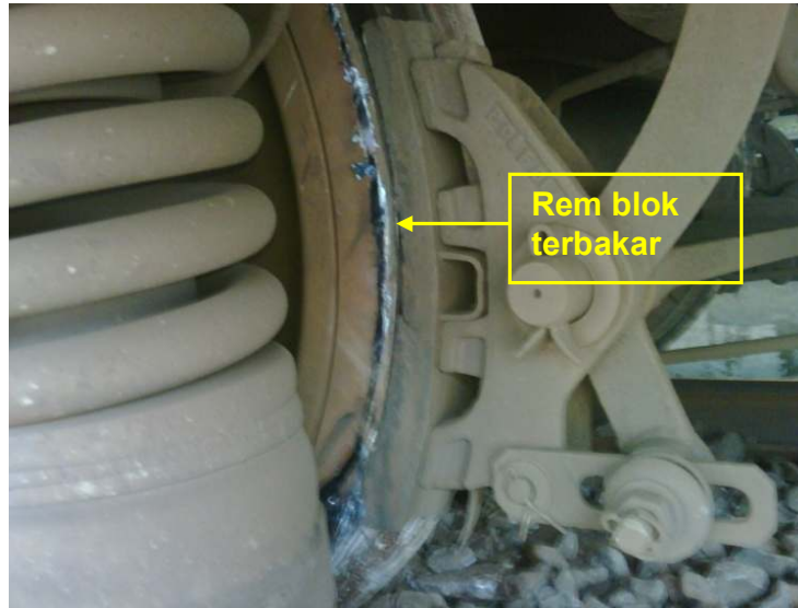
Gambar 6. Rem blok kereta B 08514 yang terbakar
