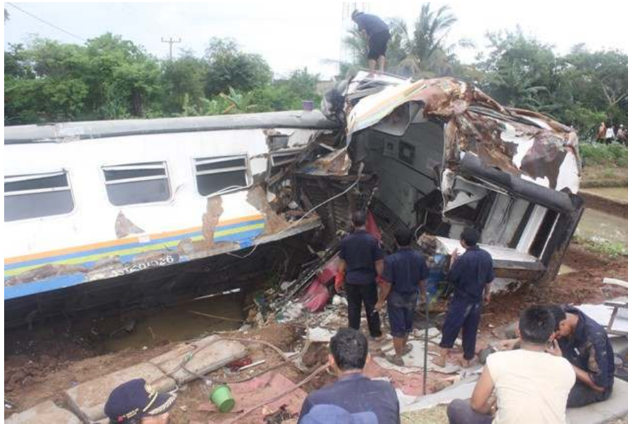
Gambar 2. Kereta K2 81526 patah menjadi 2 (dua) bagian
