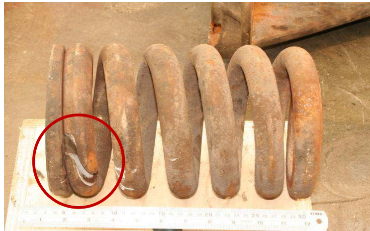
Gambar 9. Pegas dukung pada bogie K2 78506 patah
