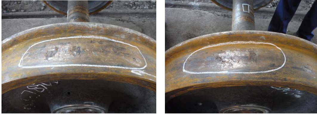
Gambar 7. Bagian roda yang dilingkari menunjukkan tempat benjolan pada roda
