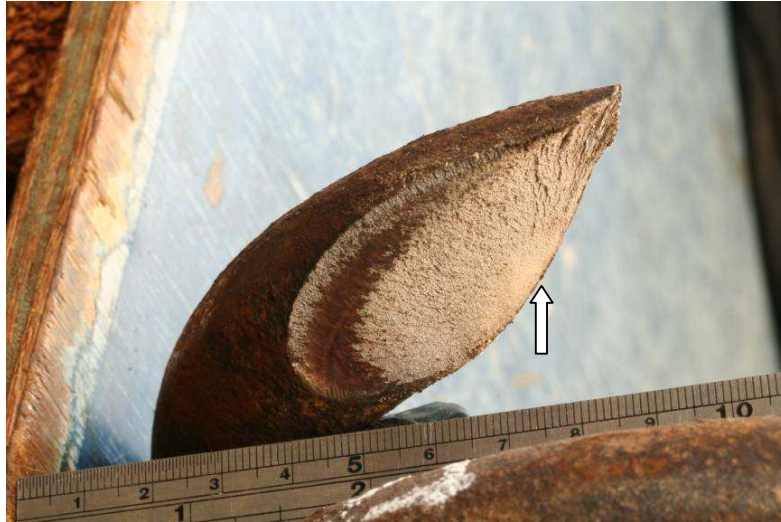
Gambar 10. Tanda panah menunjukkan titik awal retak fatigue
