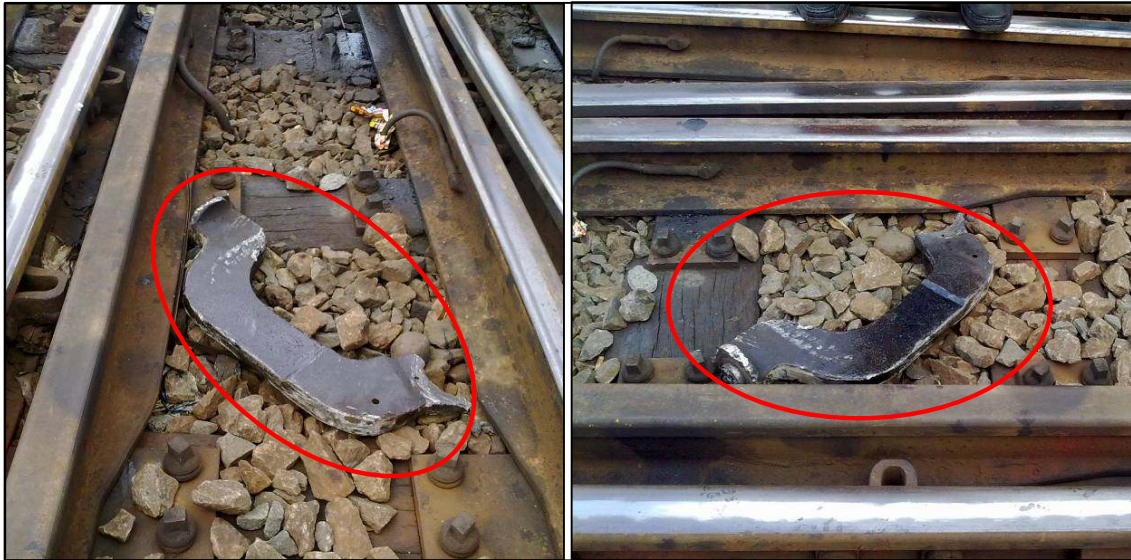
Gambar 7. Potongan gantungan gearbox yang patah di emplasemen St. Manggarai
