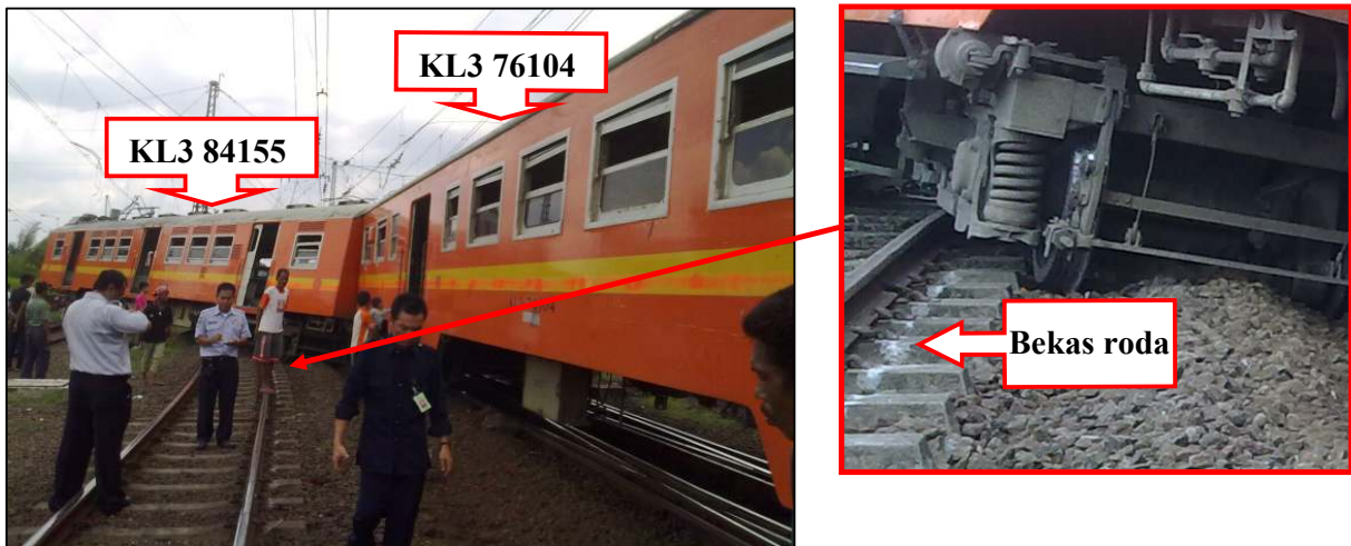
Gambar 5. Bekas roda bogie ke-2 KL3 84115 pada bantalan-bantalan beton di Jalur II emplasemen St. Manggarai
