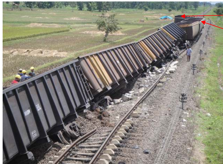
Gambar 7. KKBW ke-46 gerbong terakhir (S21) di jalur II dan gerbong ke-44 di jalur I , kedua gerbong tidak anjlok
