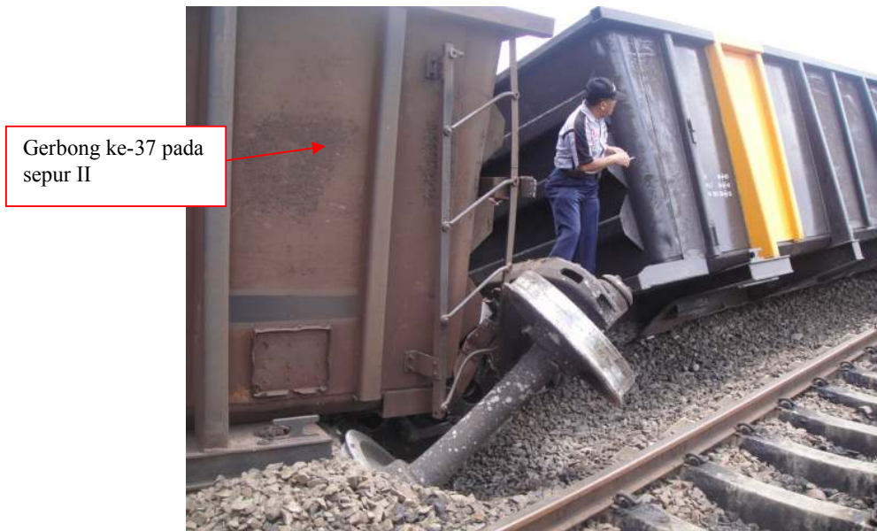
Gambar 8. KKBW gerbong ke-37 dan KKBW rangkaian ke-38 anjlok di jalur II
