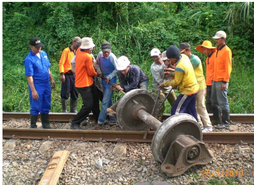
Gambar 7. Salah satu as roda K2 82505 yang terlepas
