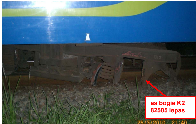
Gambar 6. Bogie kereta K2 82505 yang terlepas 1 as perangkat roda
