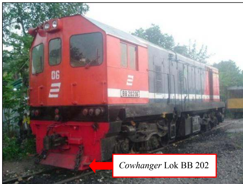
Gambar 8. Konstruksi cowhanger Lokomotif tipe lama Lok BB 202 yang miring
