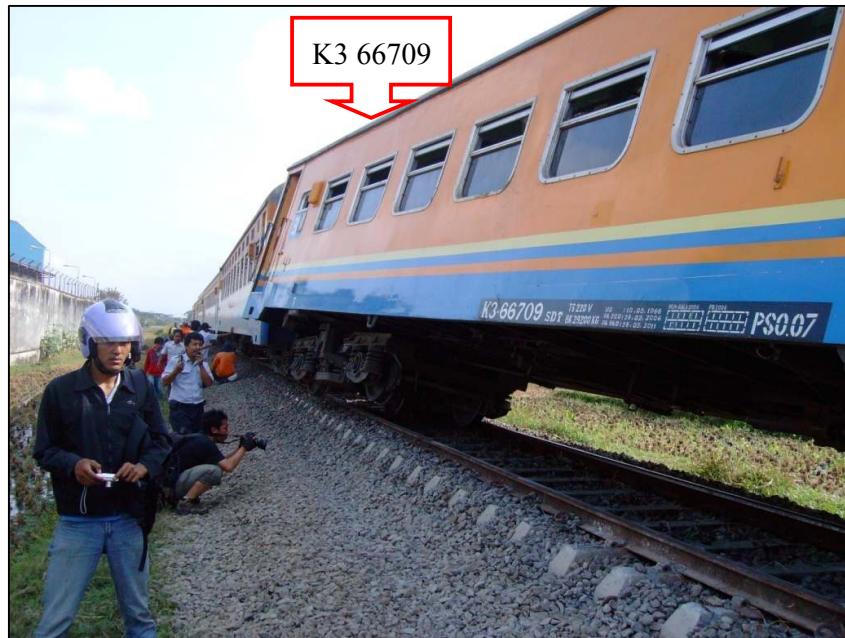
Gambar 5. Kereta K3 66709 anjlok 4 as dan miring ke kiri
