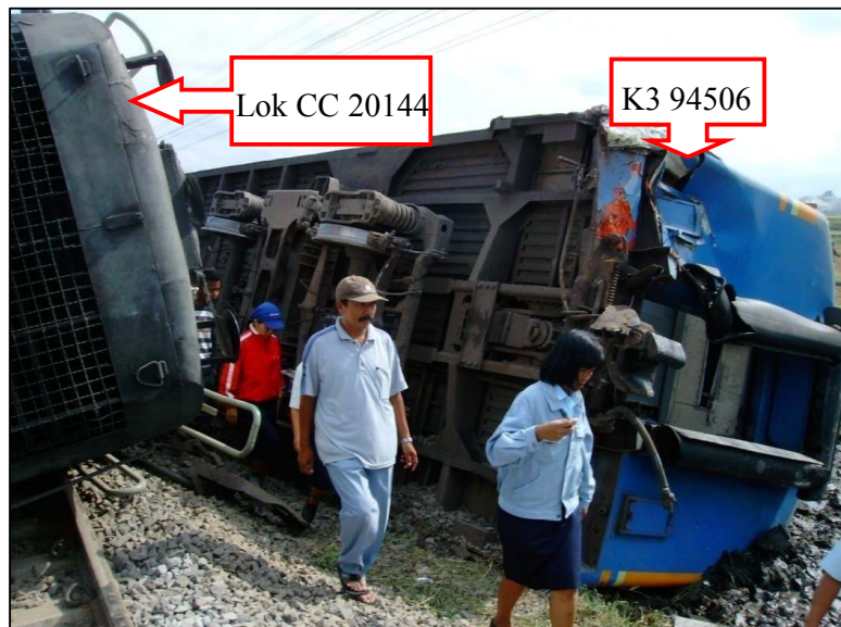
Gambar 4. Kereta K3 94506 terguling ke arah kiri jalan rel
