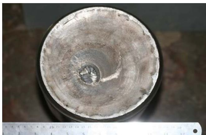
Gambar 8. Permukaan patah pada as sisi keping roda. Beachmarks (lingkaran-lingkaran perambatan retak dari tepi ke arah tengah). Di bagian tengah adalah patah akhir ( final failure )
