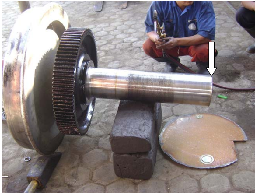
Gambar 4. Lokasi as lokomotif yang patah
