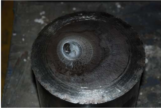
Gb.3. Permukaan patah pada as sisi bearing motor traksi. Beachmarks (lingkaran-lingkaran dari tepi ke arah tengah). Di bagian tengah adalah patah akhir ( final failure )
