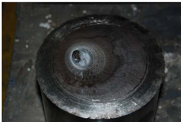
Gambar 7. Permukaan patah pada as sisi bearing motor traksi. Beachmarks (lingkaran-lingkaran dari tepi ke arah tengah) di bagian tengah adalah patah akhir ( final failure )
