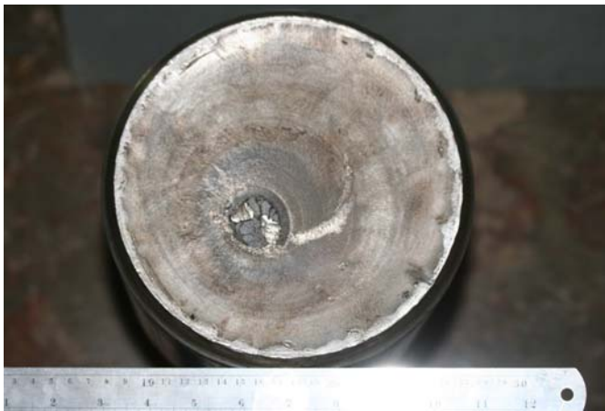
Gb.4. Permukaan patah pada as sisi keping roda. Beachmarks (lingkaran-lingkaran perambatan retak dari tepi ke arah tengah). Di bagian tengah adalah patah akhir ( final failure )
