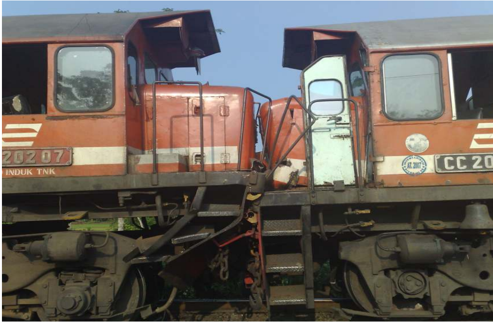
Gambar 3. Posisi Lokomotif CC20207 (lokomotif depan KA BBR 16) dan lokomotif CC20229 (lokomotif depan KA BBR 9) saat tumburan
