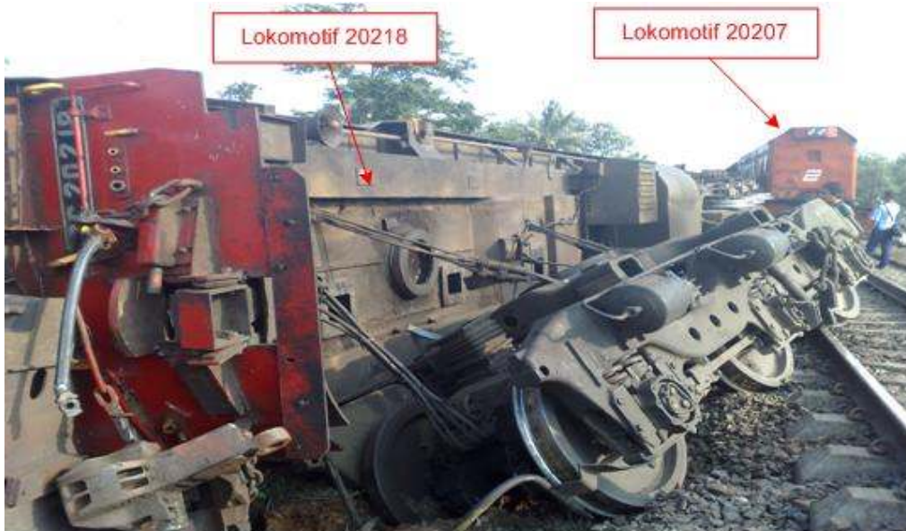
Gambar 4. Lokomotif CC 20218 (lokomotif kedua KA BBR 16) yang terguling dan lokomotif CC20207 anjlok 6 as
