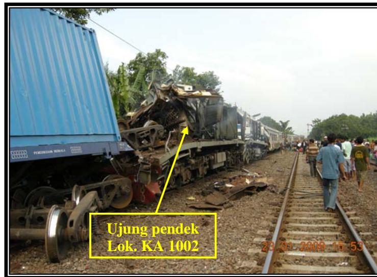
Gambar 6. Ujung pendek Lokomotif CC 20180 dari KA 1002 rusak parah akibat terbentur Gerbong PPCW
