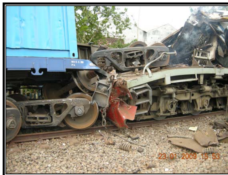
Gambar 7. Gerbong PPCW terlempar ke atas dan menghancurkan ujung pendek kabin Lokomotif CC 20180 dari KA 1002
