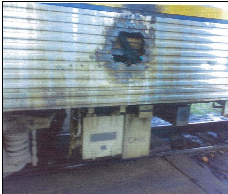
Gambar 3. Dinding KL1 6187 yang terbakar
