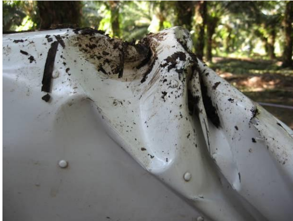
Gambar 3 Leading edge sayap kiri menabrak pohon
