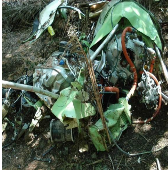
Gambar 8 Kondisi engine pesawat di lokasi kecelakaan
