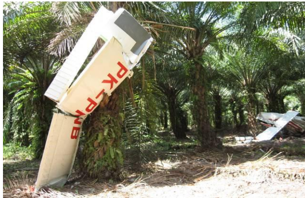
Gambar 4 Sayap sebelah kanan terlepas dari fuselage
