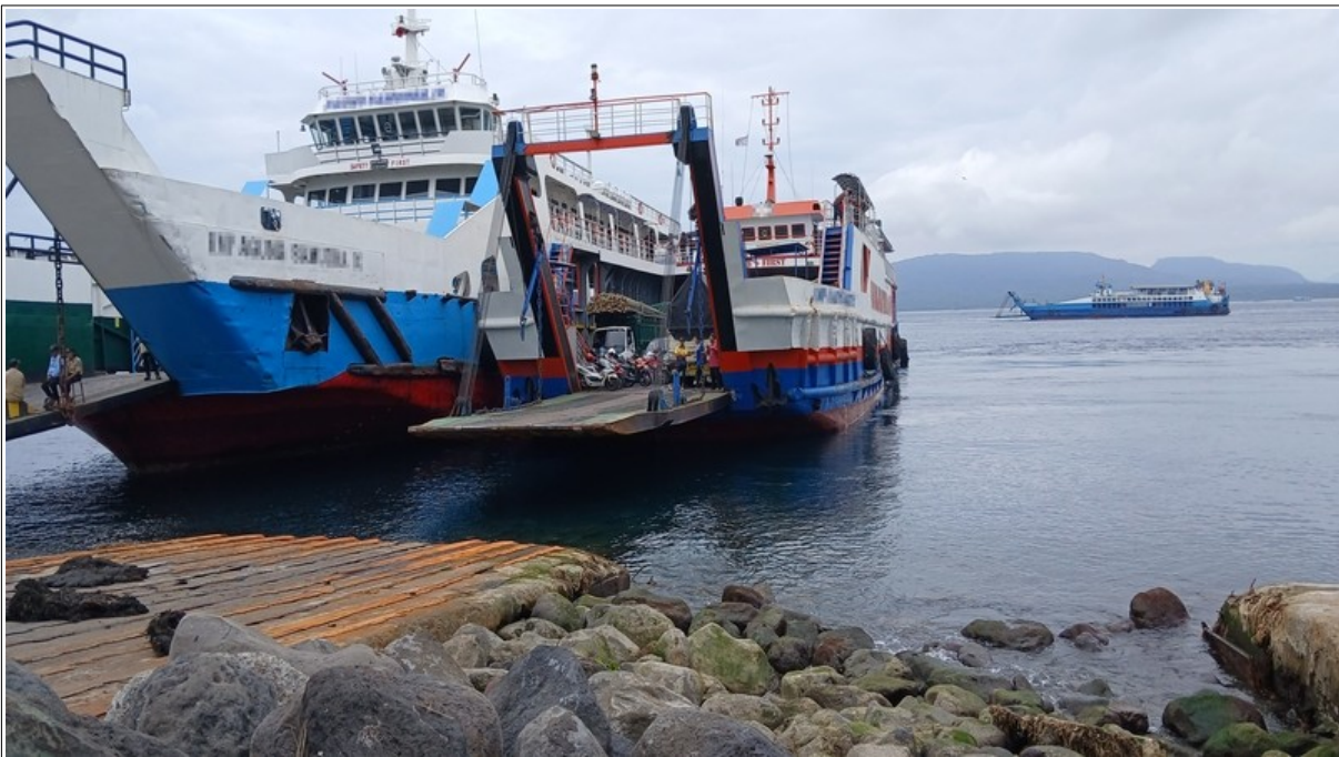
Gambar II-5: Salah satu contoh kapal overdraft (kanan) yang dapat dilihat dengan mudah dari rampa darat Dermaga LCM Ketapang. Gambar: KNKT.
