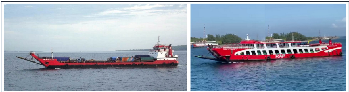
Gambar I-12: TPJ sebelum modifikasi (kiri) dan setelah modifikasi (kanan). Gambar: Marine Traffic dan media sosial.
