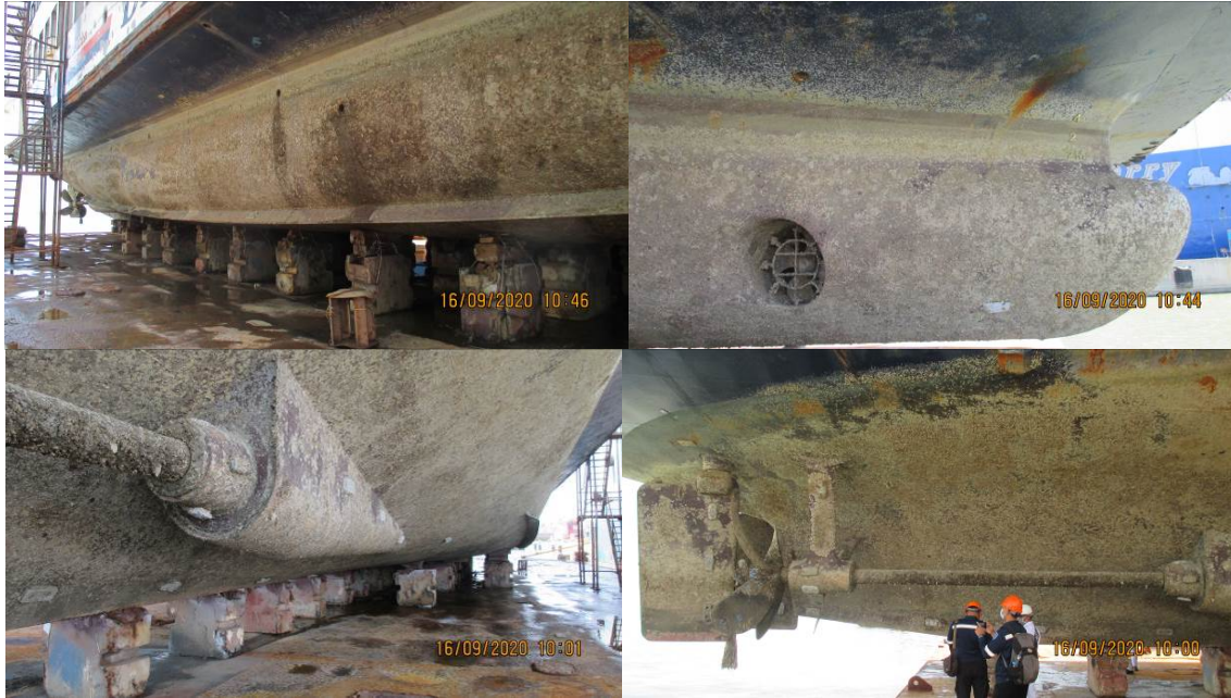
Gambar I-30: Kondisi lambung kanan Dharma Rucitra III
