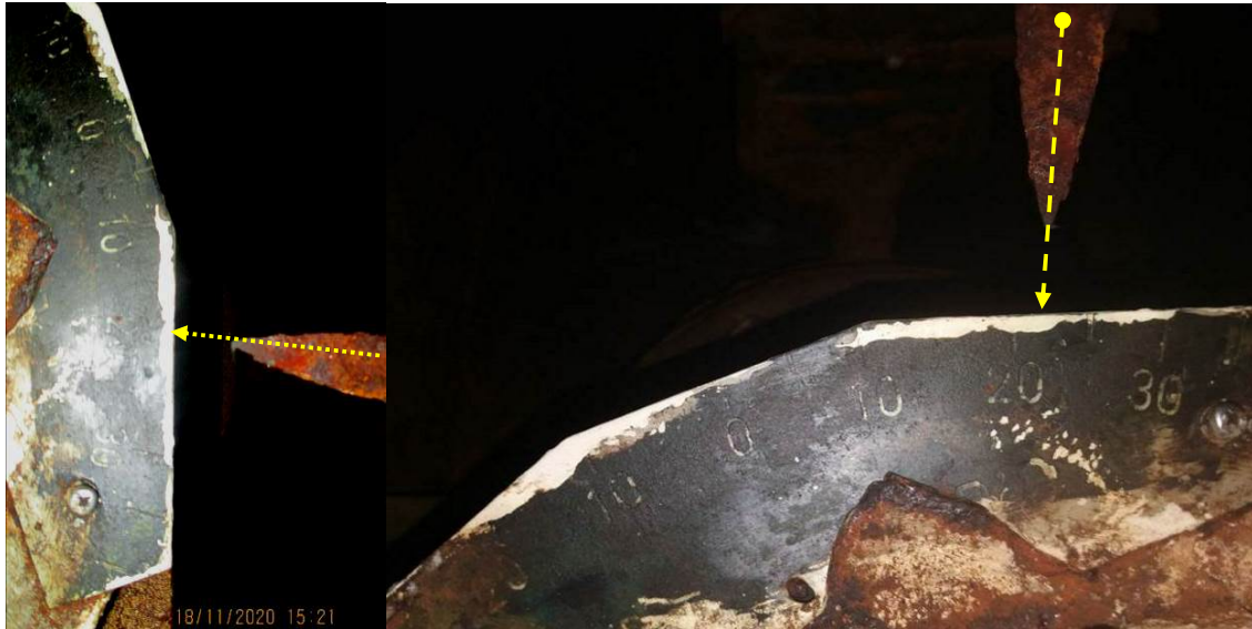
Gambar I-35: Jarum pada piringan indikator sudut kemudi menunjuk ke sudut sekitar 20-22 derajat kanan
