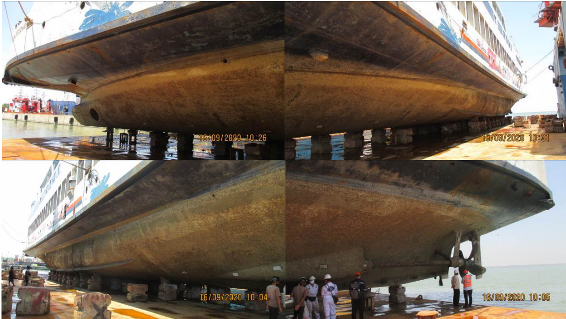
Gambar I-31: Kondisi lambung kiri Dharma Rucitra III
