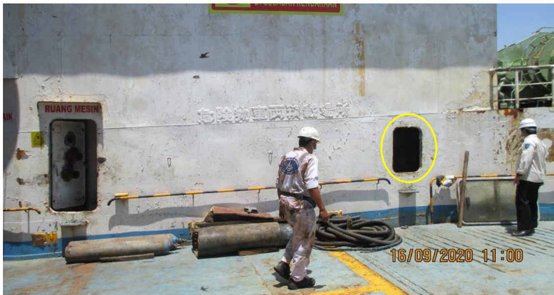
Gambar I-10: Akses ke steering gear room (lingkaran kuning) berada di sebelah akses kamar mesin
