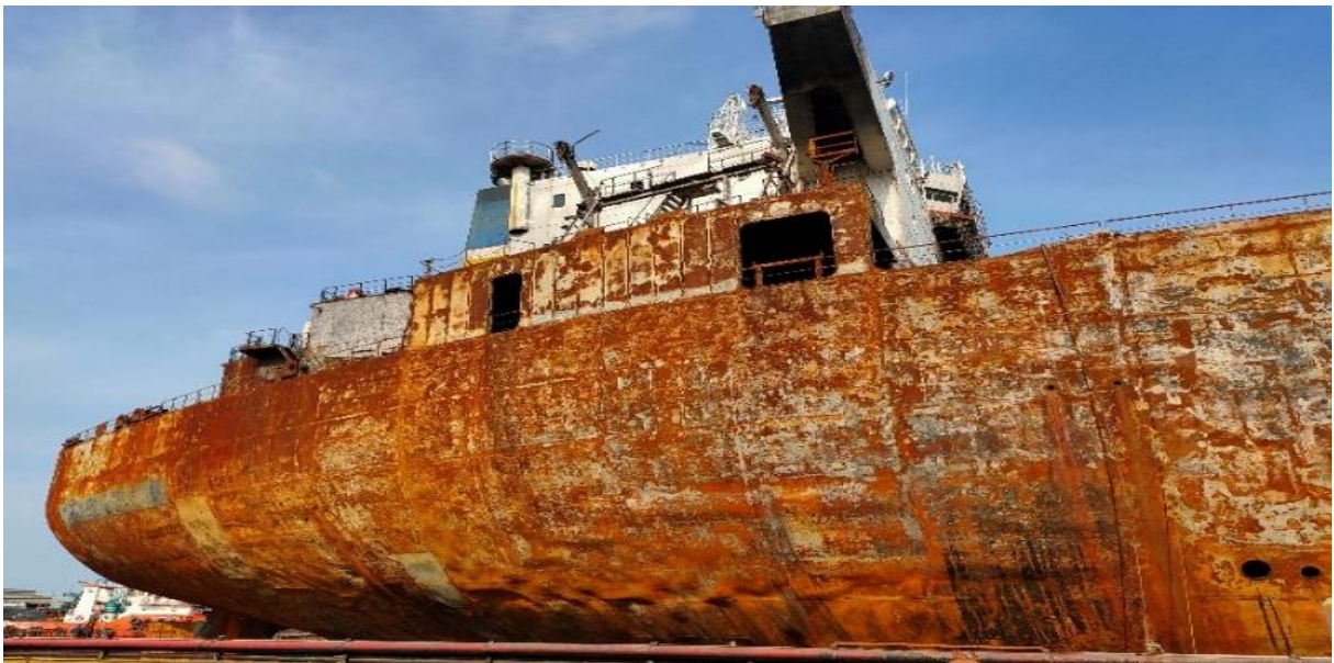
Gambar I-4: Kondisi Jag Leela akibat kebakaran
