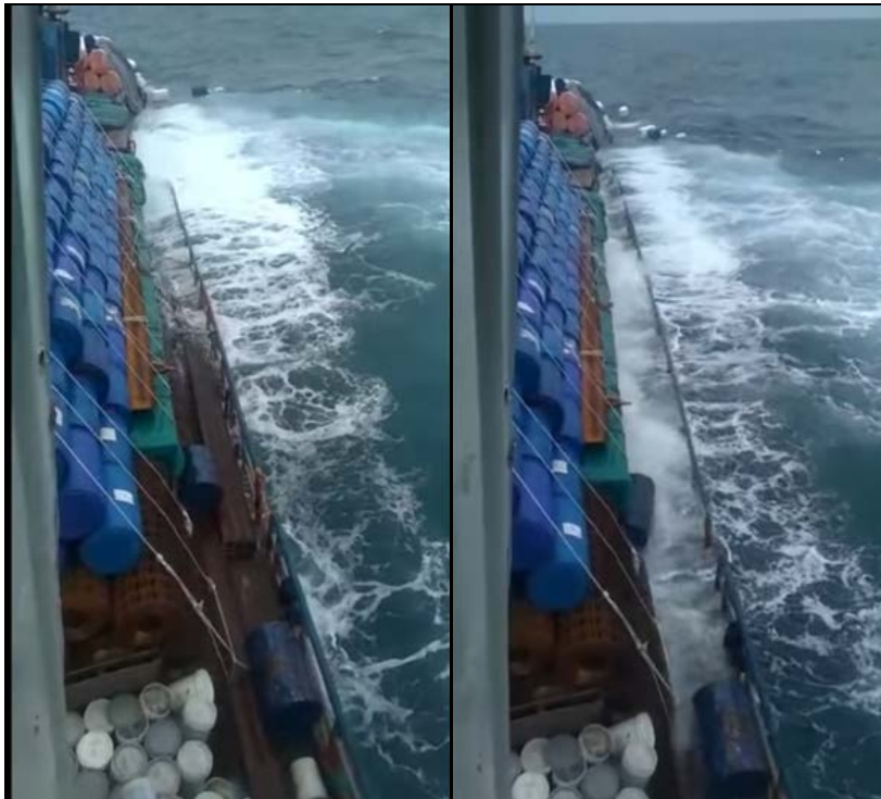
Gambar II-1: Lambung timbul yang kecil membuat air laut mudah naik ke geladak
