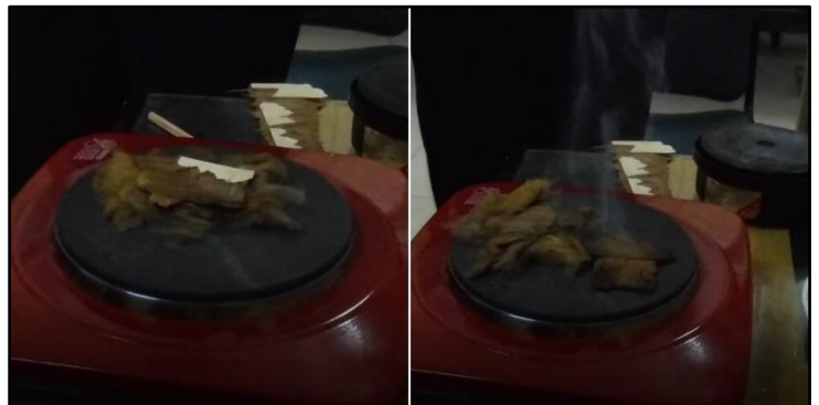
Gambar 6: Loose rockwool ditempatkan di antara sumber panas dan plywood (kiri); plywood langsung berasap ketika ditempelkan langsung pada sumber panas (kanan)
