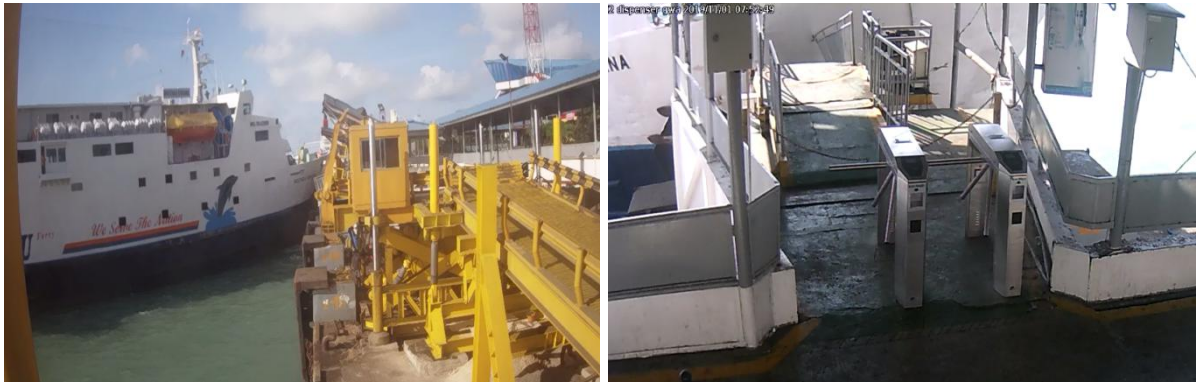
Gambar 2: Posisi Kapal Pada Saat Menyenggol Gangway Penumpang (Kiri). Sudut Pandang Kamera Gangway (Kanan)
