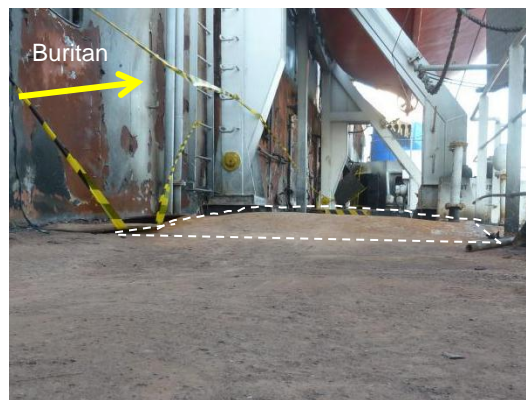
Gambar I-23: Deformasi Pelat Geladak A kiri Tepat di Atas Area Truk A
