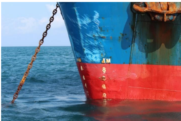
Gambar 2: Bagian haluan Mellinda tampak tergores akibat tubrukan dengan Rezeki Penuh 1
