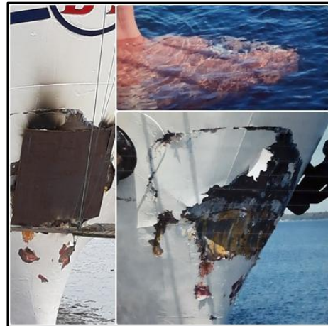
Gambar 3: Kerusakan pada linggi haluan Prince Soya
