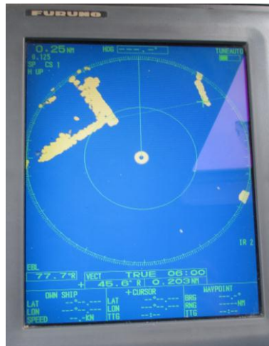
Gambar 12: gambar Jarak ujung pelabuhan dan ujung break water menggunakan radar kapal patroli KSOP Merak
