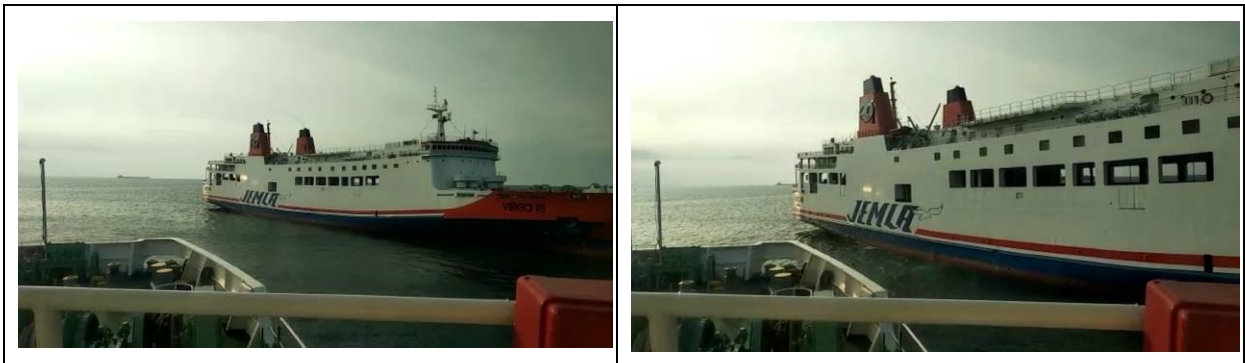
Gambar 14: gambar Posisi Windu Karsa Dwitya saat instruksi kemudi ke kiri cikar dan instruksi bow thruster ke kiri
