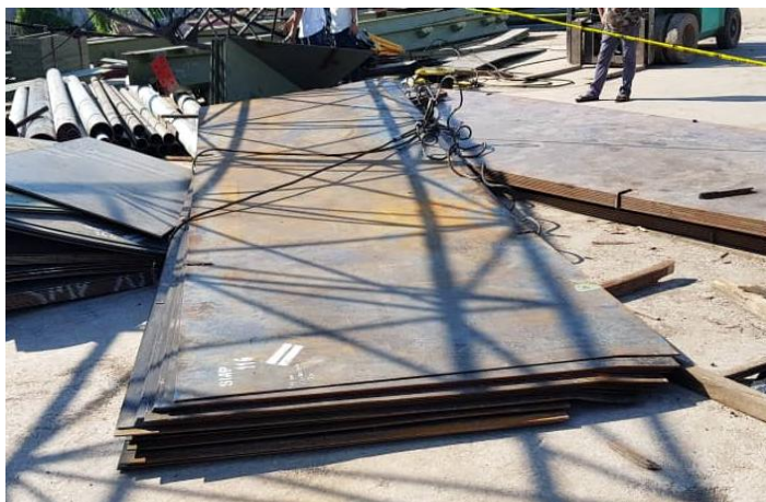
Gambar 5: 26 lembar material pelat 6mm yang diangkat oleh derek Bistari 8 pada saat patah
